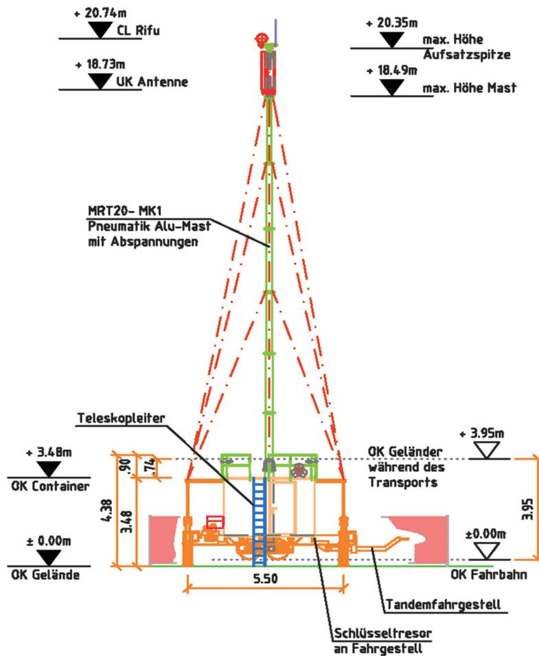
mrt20-mk1 ist die Bezeichnung für eine mobile Basisstation, welche mit einem integrierten Fahrwerk als eigenständiges Anhängersystem transportiert werden und vor Ort hydraulisch abgesetzt werden kann. Der aufgesetzte Technikcontainer bindet einen pneumatisch ausfahrbaren Aluminiummast ein. Das Gesamtsystem kann innerhalb kürzester Zeit (1-2 Stunden) aufgebaut und anschließend in ein bestehendes Mobilfunknetz integriert werden.
