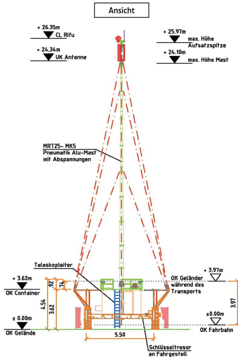
mrt25-mk5 ist die Bezeichnung für eine mobile Basisstation. Bei dem System handelt es sich im Wesentlichen um ein separat hydraulisch absetzbares Gestell mit einem aufgesetzten Technikcontainer und einem integrierten pneumatisch ausfahrbaren Aluminiummast. Der speziell hierzu konzipierte Wechselfahrzeugträger\* zum Transport des mrt20-mk5 kann mit einem herkömmlichen LKW mit Ringmaulkupplung und Druckluftbremsanlage gezogen werden.
