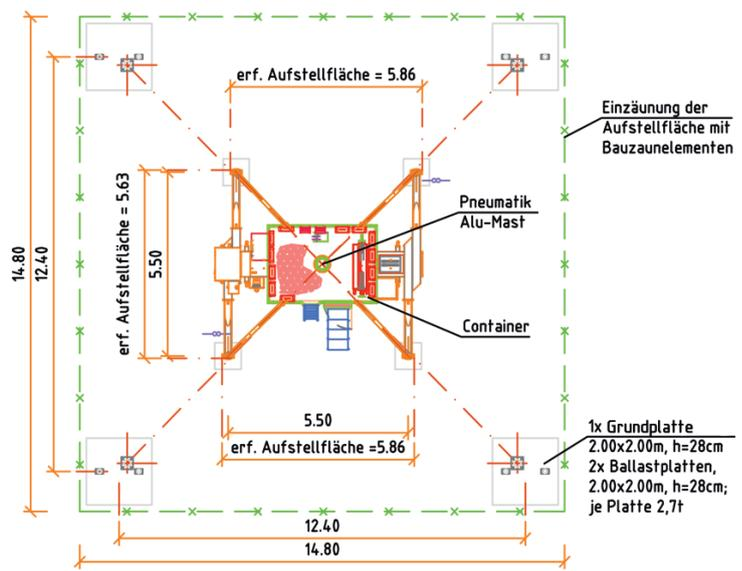
mrt30-mk4 ist die Bezeichnung für eine mobile Basisstation, welche mit einem separatem Wechselfahrzeugträger transportiert werden und als eigenständiges System vor Ort hydraulisch abgesetzt werden kann. Der aufgesetzte Technikcontainer bindet einen pneumatisch ausfahrbaren Aluminiummast ein. Das Gesamtsystem kann innerhalb kürzester Zeit (3-4 Stunden) aufgebaut und anschließend in ein bestehendes Mobilfunknetz integriert werden.
